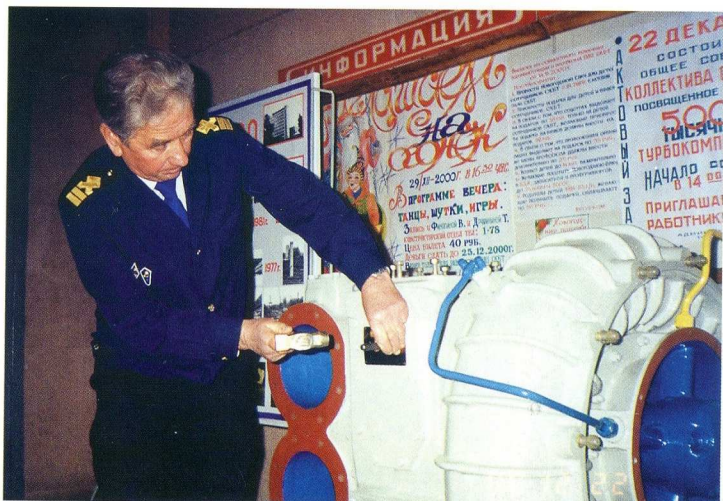
Инженер-инспектор инспекции Морского Регистра А. Н. Батяйкин принимает судовой турбокомпрессор ТК41В-08, заводской № 5000
